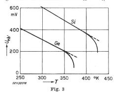
Temperaturabhängigkeit der Basisemitterspannung für eine bestimmte Einstellung
