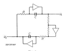
Fig. 1 Schaltung zur Lösung einer Differentialgleichung
