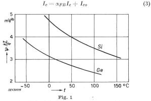
Temperaturabhängigkeit des Temperaturkoeffizienten  $\psi$  Temperaturkoeffizient; kT/q Temperaturspannung; Si Silizium; Ge Germanium
