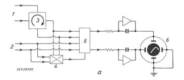
Durch Speichern des Spitzenwertes von  $U_2$  wird die Amplitude U erhalten, während die Zeit  $t_0$  proportional zum Winkel  $\Phi$  ist.
