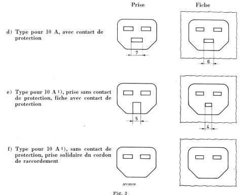
Prises et fiches de connecteur de 250 V pour endroits de raccordement chauds jusqu'à 155 °C
