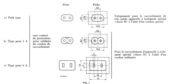
Prises et fiches de connecteur de 250 V pour endroits de raccordement froids jusqu'à 65 °C
