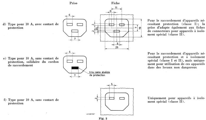
Prises et fiches de connecteur de 250 V pour endroits de raccordement chauds jusqu'à 155 °C
