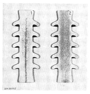
Fig. 2 Schnitt durch poröse Vollkernisolatoren (Fuchsinprobe)
