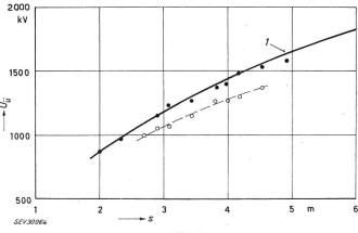
Fig. 2 Abhängigkeit der Überschlagsspannung von der Länge der Isolatorenkette,  $U_{ii} = f(s)$
