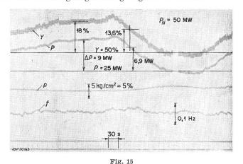
Peltonturbine unter Einfluss eines digitalen Netzreglers
