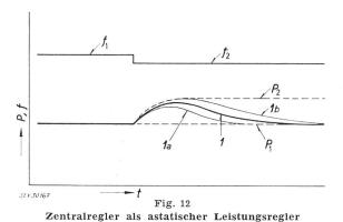
Leistungsverlauf bei Netzfrequenzänderung 1a kleine, 1 mittlere, 1b grosse Nachstellzeit f Netzfrequenz; P Maschinenleistung;  $P_1$  Solleistung mit Zentralregler;  $P_2$  Leistung der Maschine ohne Zentralregler; t Zeit
