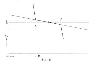
Die eine Möglichkeit besteht darin, einen Zentralregler als Leistungsregler zu benützen. Die Summe der Leistungen, bzw. der Öffnungen der angeschlossenen Maschinen wird mit einer Soll-Leistung verglichen. Bei einer Störung im Netz reagieren die an-
