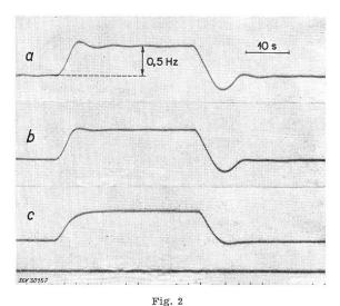
Leerlauffrequenz einer Peltonturbine bei Sollwertstössen a schwache, b mittlere, c starke Stabilisierung
