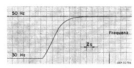
Fig. 9 Automatischer Anlauf einer Francisturbine 88 000 PS
