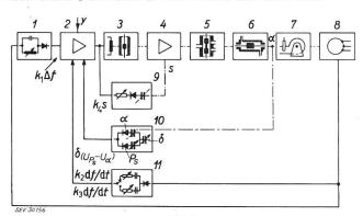
Fig. 1 Blockschema des elektrischen Turbinenreglers
