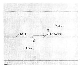
Fig. 8 Leerlaufdrehzahl einer Peltonturbine, geregelt mit elektrischem Turbinenregler Typ ERW
