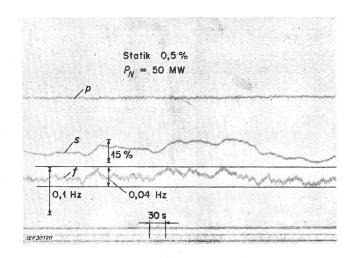
Fig. 10 Reaktion einer Turbine, die mit 0,5 % Statik mit dem Netz parallel geschaltet ist
