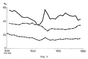
Valeurs relatives de la charge maximum du réseau, de la puissance installée des transformateurs de distribution et de la puissance raccordée
