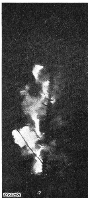
Fig. 7 Lichtbogen 0,08 s (a) und 0,49 s nach der Zündung (b)
