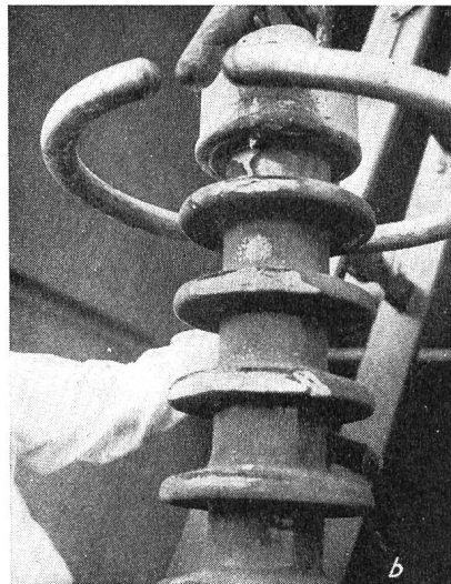
Fig. 5 Zerstörungen an Isolatoren nach einem Lichtbogenüberschlag
