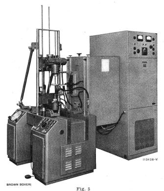
Universal-Härtemaschine mit automatischer Programm-Schablonen-Steuerung und Hochfrequenzgenerator 10 kW
