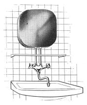
Fig. 2 Kleinheisswasserspeicher
