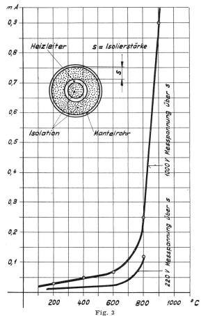
Ableitstrom  $I_{ab}$  in Funktion der Oberflächentemperatur
