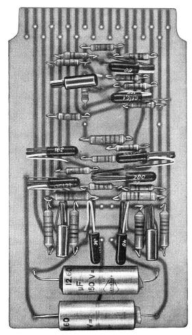
${\bf Fig.} \ 1$  **Elektronische Einheit auf gedruckter Leiterplatte**
