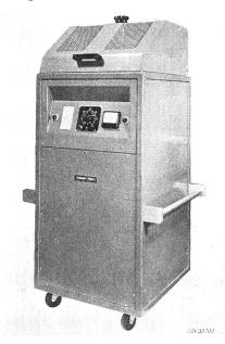
Fig. 3 Générateur de chauffage haute fréquence à usage industriel Puissance 1,5 kW
