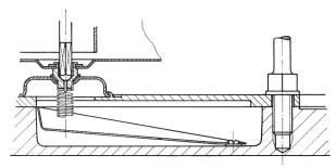
Fig. 1 Verdampfungskammer mit Tropfdüse des Dampfbügelautomaten «Jura», Typ 1360
