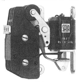
Fig. 1 Neues Schaltschütz Typ SBR, mit kunstharzvergossener Spule Stoßspannungsprüfung 1|50 mit 8 kV
