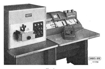
Anlage für die automatische Messwertverarbeitung zum impulsgesteuerten Mittelwertdrucker Maxiprint-Color
