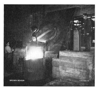
Fig. 4 Netzfrequenz-Induktionsschmelzofen für das Schmelzen und Überhitzen von Grauguss
