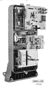
Für grössere Übertragungsdistanzen wird man vielfach dem Impulsfrequenzverfahren den Vorzug geben (Fig. 3). Dieses System ist besonders wirtschaftlich und zuverlässig und gestattet die Fernmessung von nahezu allen physikalischen Grössen; wobei dies durch einen entsprechenden Umformer auf relativ einfache Weise in messwertproportionale Impulsfrequenzen umgewandelt werden. Die Messgenauigkeit ist unabhängig von der Art und Länge des Über-
