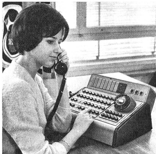
Fig. 2 «Albis»-Vermittlungsstation mit Leuchttasten und eingebautem Nummernanzeiger
