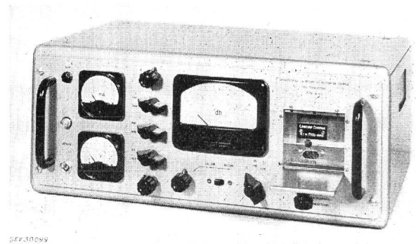
Fig. 3 Appareil pour la mesure du souffle des transistors
