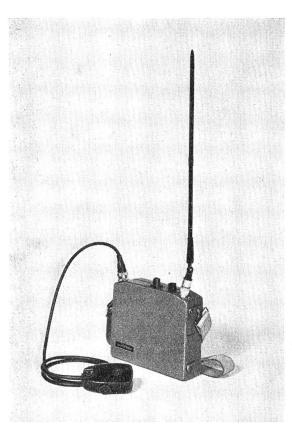
Fig. 1 Funktelephon SE 18 oben: Anschluss für Bedienungsgerät, Kanalwähler,  ${\bf Squelch\hbox{-} Schalter,\ Antennenanschluss;}\ \ links\ \ vorne:\ {\bf Monophon\ mit}$ Sprechtaste, Ruftaste und Ein-Aus-Schalter
