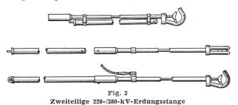
Die neue zweiteilige 220-/380-kV-Erdungsstange (Fig. 3) hat als Klemmenträger ein Aluminiumrohr, das gleichzeitig zur Leitungsführung dient. Der hintere Teil der Stange ist aus einem glasfaserverstärkten Polyesterrohr mit hervorragenden elektrischen und mechanischen Werten ausgeführt. Die Wasseraufnahme ist sehr gering, so dass sich selbst nach längerer Beregnung die Isolierwerte nicht wesentlich ändern.
