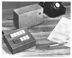
Fig. 2 Vivavox-Hauptstation
