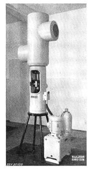
Auf die in Dampfanlagen benutzten Teile will das vorgeführte Regelorgan mit autonomem hydraulischen Servomotor undelektrischem Signaleingang aufmerksam machen (Fig. 1); das Modell einer vom Servomotor gehobenen SBB-Dampflokomotive soll zeigen, welche Kräfte zum Antrieb grosser Regelventile aufzubringen sind. Das Gewicht dieser Lokomotive von 75 t entspricht näm-lich der Verstellkraft des Servomotors dieses Regelorganes.
