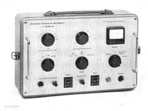
Fig. 1 Générateur d'impulsions apériodiques Type B-529/a
