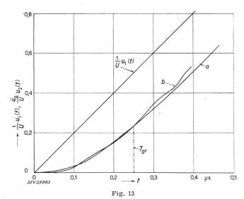
Wie Fig. 9, aber mit einem Dämpfungswiderstand von R  $_s=$  500  $\Omega$  und einer Ersatzkapazität von C = 300 pF
