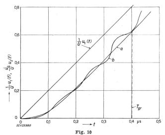
Wie Fig. 9, aber mit einem Dämpfungswiderstand von  $R_s=300~\Omega$  und einer Ersatzkapazität von  $C=300~\mathrm{pF}$  Bezeichnungen siehe Fig. 9
