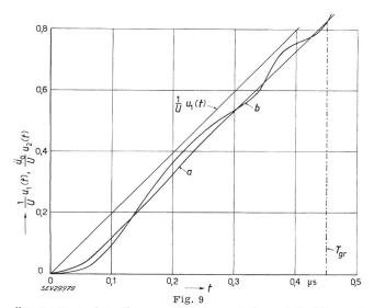
Übertragung eines linearen Steilstosses bei vereinfachter und genaueren Darstellung der Zuleitung einer Messanordnung mit Dämpfungswiderstand  $R_s=300~\Omega$  und Ersatzkapazität  $C=100~\mathrm{pF}$
