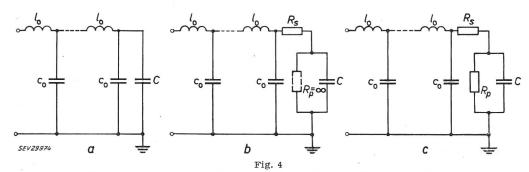
Abschlussimpedanzen  $Z_2$  der Zuleitung für verschiedene Spannungsteiler a Messanordnung mit kapazitivem Teiler
