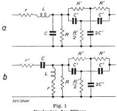
Varianten des Filters a Tiefpassfilter; b Hochpassfilter
