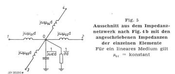
In der dargelegten Form kann das Analogienetzwerk zur Analyse von elektromagnetischen Wellen verwendet werden, um so Eigenresonanzen, Felder, Gütefaktoren usw. in Hohlleitern oder Hohlräumen zu bestimmen. Entsprechende Analogien lassen sich ebenfalls für andere einfache Felder angeben [8].
