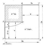
Fig. 6 Symmetrisches 90 °-Winkelprofil aus einem Medium der feldunabhängigen Permeabilität  $\mu=\mu_0\mu_r, \, {\rm umgeben} \, \, {\rm von} \, \, {\rm Luft} \, \, {\rm mit}$   $\mu=\mu_0$  Bezeichnungen siehe im Text
