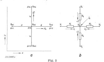
Feldausschnitt (a) zur Umsetzung der Differentialgleichung für  $V_m$  in eine Differenzengleichung und Ausschnitt (b) aus dem analogen Widerstandsnetz mit dem zusätzlichen Einspeisestrom  $I_0$
