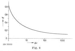
Streukoeffizient  $\sigma=\Phi_\sigma/\Phi_h$  in Funktion von  $\mu_r$  für das Winkelprofil nach Fig. 6
