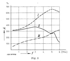
Spektralverteilung der statistischen Schwankungen I Transistorverstärker; II Transistorverstärker mit Resonanzanhebung; III Röhrenverstärker
