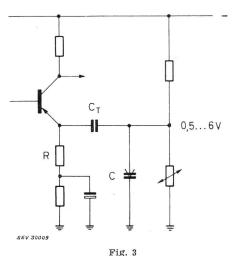
Kompensationsschaltung gegen den Temperaturfehler der Eingangsstufe
