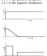
Fig. 2 Funktionsverläufe des Ein-Aus-Reglers
