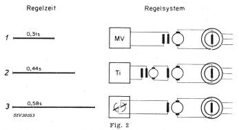
Vergleichsversuche mit drei verschiedenen Spannungsreglern an einem Generator 23 MVA, 750 U./min
