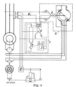
Schema für die Stabilisierung der Turbinenregelung durch zusätzlichen Frequenzregler
