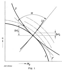
Charakteristik des Drehmomentes  $M_d$  in Abhängigkeit von der Drehzahl n von Turbinen und Generatoren mit frequenzabhängiger und -unabhängiger Belastung
