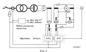
Equipement du réglage automatique d'un alternateur de grande puissance
