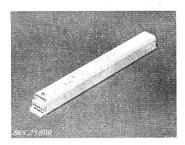
chauffage. Enroulements en fil émaillé. Condensateur de déparasitage en parallèle avec la lampe. Boîtier en tôle de fer. Bornes disposées à l'une des extrémités. Vis de mise à la terre. Appareil pour montage dans des luminaires.
