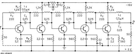
gangsspannung von 0,1 V über 50 Ω. Durch Veränderung des Arbeitspunktes der letzten Stufe könnte die verfügbare Leistung etwas vergrössert werden.
