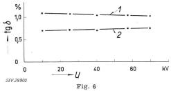
Spannungsabhängigkeit der dielektrischen Verluste tg $\delta$  einer gesteuerten Giessharzdurchführung von  $U=60~\mathrm{kV}$  1 nach einer Lagerung von 7 Tagen in relativer Luftfeuchtigkeit von 93 %; 2 trocken
