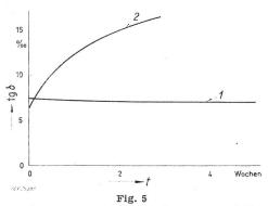
Dielektrischer Verlustfaktor tg $\delta$  von ungeschützten Kondensator-Durchführungen in Funktion der Lagerungszeit t bei 93 % relativer Luftfeuchtigkeit 1 acetyliertes Papier; 2 gewöhnliches Papier
