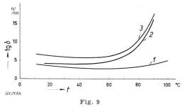
Temperaturverlauf t des dielektrischen Verlustfaktors t<br/>g  $\delta$  bei Nennspannung
