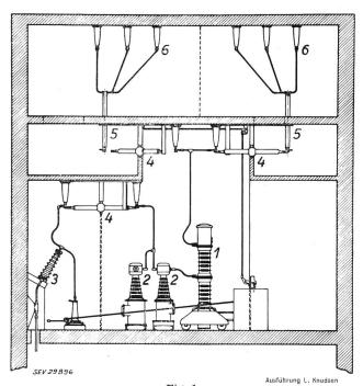
Fig. 1 Anordnung der Hochspannungsapparate in einer 60-kV-Innenraum-Verteilanlage
