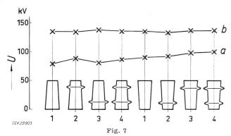
Einfluss der Schirme und deren Lage auf die Überschlagspannung von 10-kV-Epoxy-Giessharzstützern a bei Wechselspannung, 50 Hz (Effektivwerte); b bei positivem Stoss  $1 \mid 50$  (Scheitelwerte); 1...4 Stützertypen
