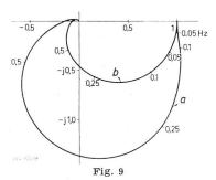
$\begin{tabular}{ll} {\bf Frequenzgang} & {\bf der} & {\bf gesamten} & {\bf Regeleinrichtung} \\ a & {\bf bei} & {\bf günstig} & {\bf eingestellter} & {\bf Rückf\"uhrung}; & {\bf b} & {\bf ohne} & {\bf R\"uckf\"uhrung} \\ \end{tabular}$
