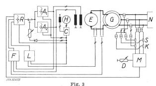
Beispiel einer Spannungsregelung mit Transduktoren
