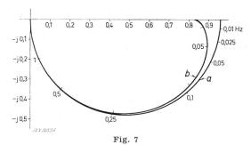
Frequenzgang einer Gleichstrommaschine (Erreger) a im Leerlauf; b belastet auf das Polrad einer Synchronmaschine
