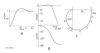
Fig. 4 Darstellungsmöglichkeiten des Übertragungsverhaltens
