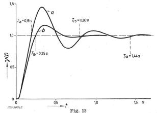
Regelzeit und Anregelzeit für zwei Übergangsfunktionen mit verschiedener Dämpfung
