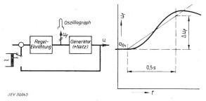
Fig. 15 System-Erregungsgeschwindigkeit  $2 \Delta U_f$
