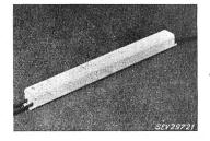
chauffage et condensateur de déparasitage. Enroulements en fil émaillé. Boîtier en tôle de fer, scellé à l'araldite. Trois cordons à conducteur isolé au caoutchouc, introduits par les extrémités du boîtier. Appareil à protection spéciale pour montage dans des luminaires étanches aux projections d'eau, pour locaux présentant des dangers d'explosion.
