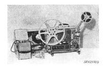
et de volume. Alimentation de l'amplificateur par transformateur et redresseur. Organes logés à demeure dans le coffre. Autotransformateur séparé pour abaisser la tension du réseau à 110...135 V.
