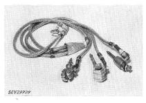
2. Bornes de phase, 3 systèmes U, V, W: U étant une borne angulaire à visser, V une borne à pinces pour cuivre méplat ou cylindrique et W un contact à enfiler sur une tige conique. Les cosses à serrage par compression sont vissées aux bornes de phase.
