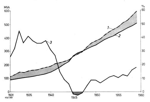
indique dans quelle proportion la puissance installée chez les abonnés pourrait être augmentée sans qu'il en résulte d'inconvénients techniques. Le graphique montre en particulier combien le réseau de Genève s'est trouvé rapidement saturé vers la fin de la guerre 1939/45 et le temps qu'il a fallu pour reconstituer péniblement une marge d'environ  $10^{\,0}/_{0}$  au cours des 15 dernières années.
