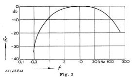
Frequenzwiedergabe eines CCIR-Zählers mit 7-m-Antenne  $g_{\tau}$  relative Verstärkung; f Frequenz
