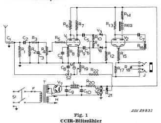
Pierce empfahl 1956 auf Grund der Analyse der elektrostatischen Feldänderung durch Blitze einen aus Filter, Thyratron oder Kaltkathodenröhre und Speicher bestehenden Erdblitzzähler für ungefähr 40 km Reichweite.
