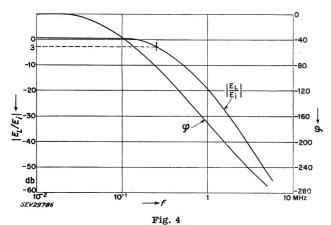
Frequenzgang des ausgeführten Rechenverstärkers
