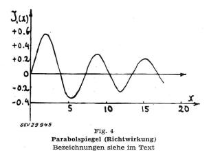
nis  $D/\lambda$ . Ist dieses gross, der Spiegeldurchmesser also ein erhebliches Vielfache der Wellenlänge, so ist die Hauptkeule schmal und die Richtwirkung gut. Dafür treten aber schon in geringem Winkelabstand Nebenmaxima auf. Diese sucht man dadurch klein zu halten, dass der Spiegel nicht gleichmässig ausgeleuchtet wird, d. h. dass die Belichtung von der Mitte gegen den Rand hin abfällt.
