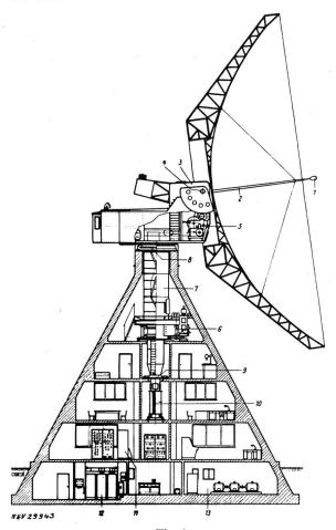
Fig. 2 Schnitt durch das 25-m-Radio-Teleskop der Universitätssternwarte Bonn auf dem Stockert
