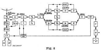
Blockschema eines Empfängers (nach C. A. Müller)  $O_1'$  und  $O_1''$  Kristalloszillatoren der ersten Mischstufe;  $O_2$  bzw.  $O_3$  der zweiten bzw. dritten Mischstufe  $M_2$  bzw.  $M_3$ ; FV Frequenzvervielfacher; ES elektronischer Schalter; S Unterdrücker; D Detektoren; A. V. C. automatische Verstärkungsregelung; SD Synchrondetektor; F Tiefpassfilter; R Schreiber
