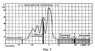
Qualitatives Bild eines Linienprofils der Wasserstoffstrahlung Die Linienstrahlung überlagert sich einer Kontinuumsstrahlung annähernd konstanter Strahlungstemperatur. Das gesamte Frequenzspektrum wird nach Art der Suchempfänger (variable Überlagerungsoszillatoren) durch ein sehr schmales Frequenzband abgetastet
