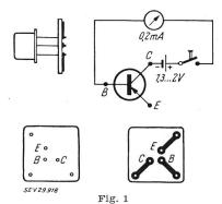
Versuchsschaltung zur Bestimmung der bei Transistoren zulässigen Lötdauer
