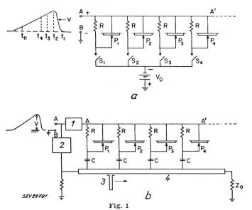
Prinzip und Arbeitsweise des «Zeit-Folge»-Teinographen a Grundprinzip; b Arbeitsweise bei schnellen Stössen 1 Stossverzögerung; 2 Impuls-Generator; 3 Impuls  $V_0$ ; 4 Impulsverzögerungsleitung
