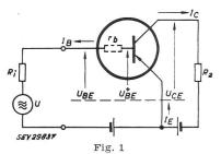
Ersatzschaltung eines Transistors
