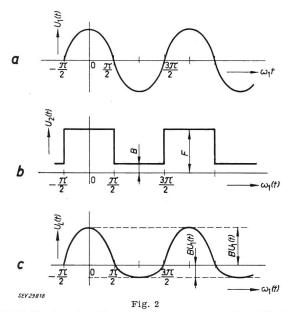
Multiplikation der Eingangsspannung (a) mit der Abtastfunktion (b) ergibt die Ausgangsspannung (c)
