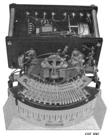
Fig. 9 Compteur à échelons de courant de Ferrari
