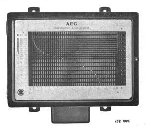
Appareil indiquant directement la courbe de charge monotone (AEG)
