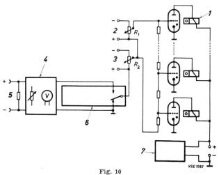
Schéma de principe de l'appareil intégrateur M 128 de Masing
