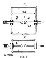
Appareil pour l'essai de la rigidité diélectrique a récipient en verre; e électrode sphérique; d couvercle en verre Cotes en mm
