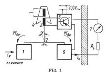
Prinzipschema der Messeinrichtung mit Messgrössenumformer  $i_x$  Messgrösse;  $i_a$  Anzeigestrom;  $\mathit{M}_{\mathit{dx}}$  Drehmoment des Eingangs-Messwerkes;  $M_{dk}$  Drehmoment des Kombinations-Messwerkes;  $R_F$  Widerstand der Fernleitung; 1 Eingangs-Messwerk; 2 Waagebalken; 3 Schwenkspule; 4 Erregermagnet; 5 Transistorverstärker; 6 Kompensations-Messwerk; 7 Anzeigegerät
