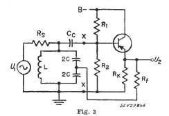
Prinzip der Entdämpfungs-Schaltung mit Transistor Bezeichnungen siehe Text
