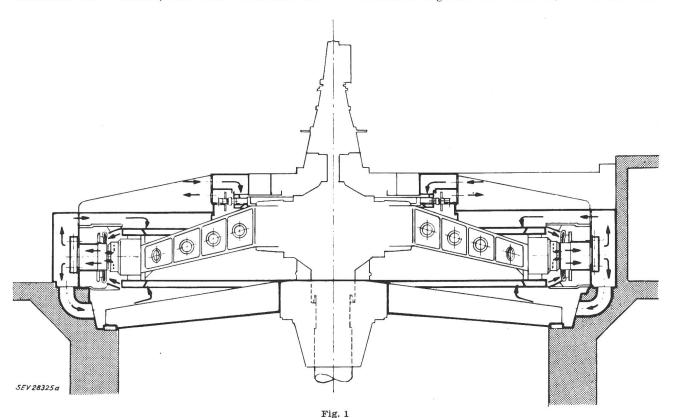
Typenzeichnung eines Generators des Kraftwerkes Birsfelden
