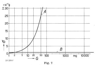
Streuung  $\sigma$  der Anzeigen in Abhängigkeit von der Belastung G $A \ \ \, \text{Elektrowaage}; \ B \ \, \text{Substitionswaage}$
