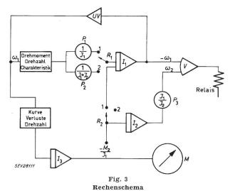
$I_1$ ,  $I_2$ ,  $I_3$  Integratoren; UV Umkehrverstärker; V Gleichspannungsverstärker;  $P_1$ ,  $P_2$ ,  $P_3$  Potentiometer; M Voltmeter;  $J_1$ ,  $J_2$  Trägheitsmomente
