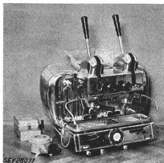
Cette machine à café peut également être chauffée au gaz. Cette machine à café a subi avec succès les essais relatifs à la sécurité de la partie électrique.
