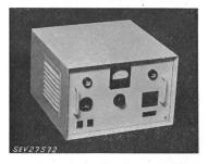
teurs à haute tension et de chauffage. Lampes à effluve et commutateurs sur la platine frontale. Amenée de courant avec fiche  $2\ P+T$ . Douille de sortie HF. Interrupteur de verrouillage dans le circuit primaire. Condensateurs de déparasitage.
