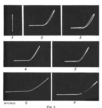
Dynamische Kennlinien dreier Germaniumspitzendioden je bei 100 kHz (2, 4, 6) und 600 kHz (3, 5, 7); I Strommaßstab 10 mA; Aussteuerungen oben und Mitte  $\hat{u}=1,0$  V; unten 1,77 V
