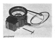
Ce thermomètre à contacts est conforme au 11° projet des Prescriptions pour le matériel antidéflagrant. Utilisation: dans des locaux présentant des dangers d'explosion.
