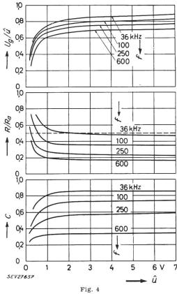
Spannungsrichtwirkung  $U_g/\hat{u}$ , normierter Dämpfungswiderstand  $R/R_h$  und Eingangskapazität C eines Spitzenspannungsgleichrichters mit Germaniumflächendiode als Funktion der Aussteuerung  $\hat{u}$  bei verschiedenen Frequenzen
