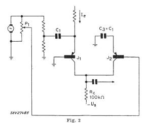
Strommodulator in Balance-Schaltung
