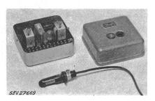
Ces appareils de commande automatique pour installations de chauffage au mazout ont subi avec succès des essais analogues à ceux prévus dans les «Prescriptions pour appareils de télécommunication» (Publ. n° 172 f). Utilisation: dans des locaux secs.
