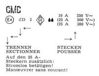
Prises de courant antidéflagrantes à protection par carter résistant à la pression, selon figure. Intérieurs en matière céramique. Broches et alvéoles argentées. Corps en fonte injectée. Poignée des fiches recouverte de caoutchouc synthétique.
