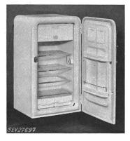
incandescence avec contact de porte. Extérieur en tôle laquée, intérieur en tôle émaillée. Cordon de raccordement à conducteurs isolés au caoutchouc, fixé au réfrigérateur, avec fiche 2 P+T. Dimensions intérieures: 860 × 420 × 420 mm; extérieures:  $1075 \times 635 \times 560$  mm. Contenance utile 126 dm<sup>3</sup>. Ce réfrigérateur est conforme aux «Prescriptions et règles pour les armoires frigorifiques de ménage» (Publ. nº 136 f).
