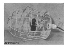
Ce radiateur infrarouge a subi avec succès les essais relatifs à la sécurité. Utilisation: dans des étables ou écuries.
