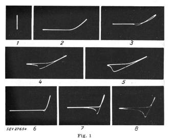
Dynamische Kennlinien zweier Germaniumflächendioden von links oben nach rechts unten: 1 Strommaßstab 10 mA; 2...5 Kennlinien bei 1, 10, 100 und 600 kHz; Aussteuerung  $\hat{u}=0.71$  V; 6...8 Kennlinien bei 1, 7,5 und 10 kHz; Vorspannung  $U_v=-1.3$  V und Aussteuerung  $\hat{u}=2.0$  V
