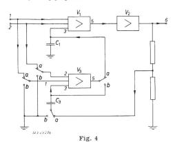
Gleichstromverstärker mit Reflex-Überwachung 1, 2 Signaleingang; 3 Fehlerspannungseingang; 5 Ausgang der Verstärker  $V_1$  und  $V_3$ ; 6 Ausgang; a Überwachungslage; b Korrekturlage;  $V_1$  Vorverstärker;  $V_2$  Endverstärker;  $V_3$  Überwachungsverstärker
