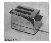
soulève les tranches rôties, tout en interrompant le circuit. Poignées en matière isolante moulée. Cordon de raccordement de section circulaire, fixé au grille-pain, avec fiche 2 P. Borne de mise à la terre.
