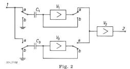
Blockschema des Gleichstromverstärkers mit Kaskaden-Ausgleich
