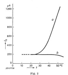
Temperaturstabilität a einzelne Transistorstufe; b Differentialverstärker  $I_{\rm o}$  Ausgangsstrom; t Temperatur in °C
