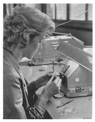
Fig. 3 Aufpunkten des Transistorelementes auf den Boden
