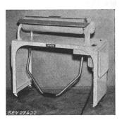
par deux ressorts contre le rouleau et pouvant en être écartée par pédale. Interrupteur à levier basculant, thermostat et lampe témoin pour le chauffage. Bâti en tôle sur galets de roulement. Cordon de raccordement à conducteurs isolés au caoutchouc, fixé à la machine, avec fiche  $2\ P+T$ . Dispositif de déparasitage.
