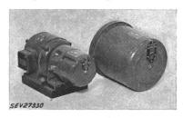
les uns contre les autres par un ressort. Lors de l'enclenchement d'un électroaimant à armature mobile, le frein est desserré par l'intermédiaire d'un jeu de leviers. Carter en métal, avec presse-étoupe pour l'introduction des conducteurs. Borne de mise à la terre. Pour utilisation en plein air, ces freins sont munis de garnitures d'étanchéité.
