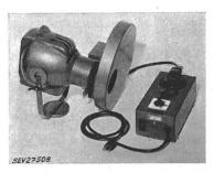
Le changeur de couleurs se compose d'une plaque portant cinq écrans de couleur, logée dans un carter en tôle et entraînée par un moteur synchrone. L'ajustage de la couleur désirée s'opère à l'aide d'un commutateur logé dans un boîtier en tôle et relié au changeur de couleurs par un câble à huit conducteurs. Une lampe témoin brille dès que l'écran de la couleur désirée est en place. Amenée de courant à l'appareil de commande par cordon sous double gaine isolante, avec fiche 2P+T
