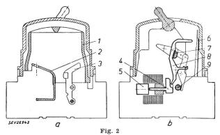
Schnittzeichnungen durch Schaltkammer (a) und Auslösemechanismus (b) des Hochleistungs-Selbstschalters S 201 1 Lichtbogenkammer; 2 Festkontakt; 3 beweglicher Kontakt; 4 Stössel des magnetischen Auslösers; 5 Schlaganker; 6 thermischer Auslöser; 7 Verklinkung des Schaltwerks; 8 Auslösehebel; 9 Verbindungsachse der beweglichen Kontakte
