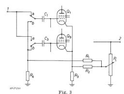
Prinzipschaltung der Verstärkungskontrolle mit Gegenkopplung 1 Eingang; 2 Ausgang; a Betriebslage; b Korrekturlage;  $P_1$  Potentiometer für Verstärkungskontrolle 50 k $\Omega$ ;  $Q_1$ ,  $Q_3$  Ein-
