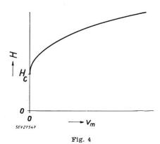
Zusammenhang zwischen der magnetischen Feldstärke H und der Ummagnetisierungsgeschwindigkeit  $v_{\it m}$
