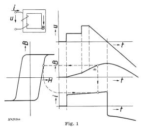
Zusammenhänge an einem Magnetkern bei bekanntem Spannungsverlauf
