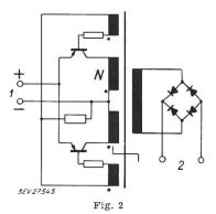
${\bf Gleich spannung s\text{-} Umformer}$
