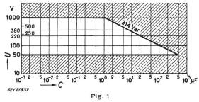
Domaine d'application des condensateurs à tension alternative Les puissances des condensateurs à tension alternative, pour lesquels les présentes Prescriptions sont valables, sont celles de la zone non hachurée. L'équation pour la limite de cette zone, dans le cas de tension alternative à 50 Hz, est la suivante:
