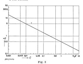
Limite de la fréquence propre  $f_0$  de condensateurs de déparasitage
