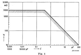
Limite inférieure de la résistance d'isolement admissible Les données (R, C) des condensateurs admissibles sont au delà de la zone hachurée
