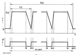
Fig. 6 Surcharge cyclique de condensateurs t Température;  $t_R$  Température ambiante;  $t_{max}$  Température superficielle maximum; Z Cycle;  $U_z$  Tension d'essai
