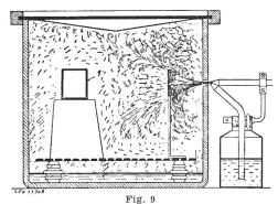
Caisse fermée et vaporisateur pour l'essai de résistance à l'humidité
