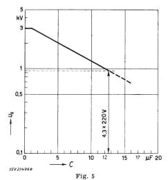
Tension de choc d'essai  $u_s$  en fonction de la capacité C
