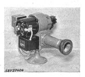
automatique «Elesta» adossé, avec cellule photoélectrique. Transformateur d'allumage avec condensateur de déparasitage, disposé latéralement contre le carter du brûleur. Point médian de l'enroulement haute tension mis à la terre. Boîte à bornes pour le raccordement de l'amenée de courant.
