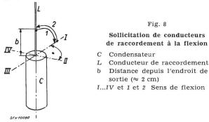
c) Les conducteurs isolés de raccordement, de chaque teinte, sont ployés en forme de boucle et plongés aussi complètement que possible dans un bain d'eau à la température ambiante. La tension d'essai requise est appliquée entre l'âme du conducteur et l'eau, immédiatement après l'immersion.
