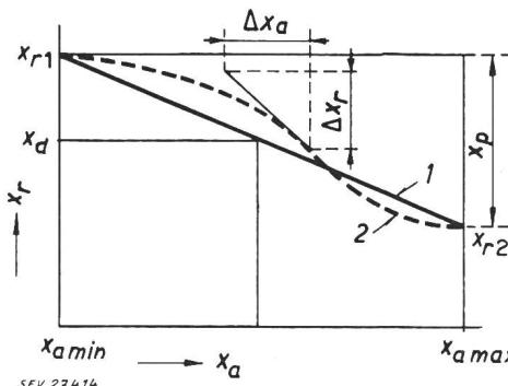
Übertragungsfaktor und relativer Übertragungsfaktor sind bei linearen P-Reglern Konstanten, d.h. vom Wert der Stellgrösse unabhängig.
