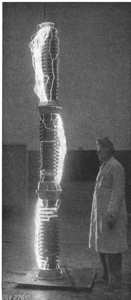
Fig. 1 Stützer im Prüffeld 50 Hz; Übersschlag bei 900 kV (Die Vergleichsperson stand während der Prüfung nicht neben dem Isolator)
