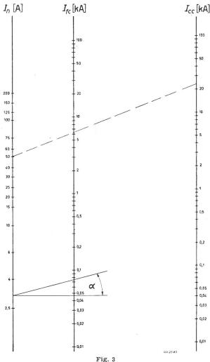
Fusible haute tension à haut pouvoir de coupure Courant de «limitation» (réellement coupé)  $I_{fc}$  en fonction du courant «présumé» (fusible shunté) de court-circuit  $I_{co}$  de l'installation et du courant nominal  $I_n$
