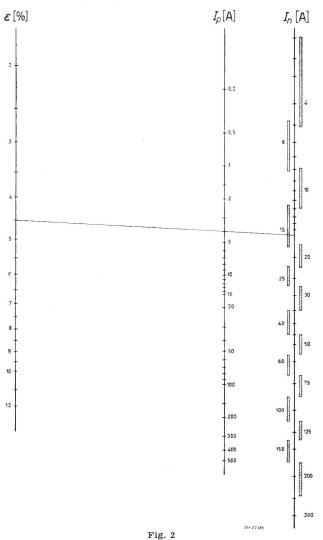
Calibrage des fusibles HT de courants nominaux  $I_n$  en fonction du courant (HT) du transformateur  $I_p$  et de la tension de court-circuit  $\varepsilon$
