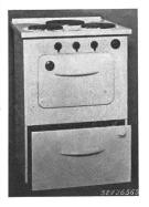
Cuisinière électrique, selon figure, avec trois foyers de cuisson, un four et un tiroir chaud. Cuvette fixe. Plaques de cuisson avec bord en tôle d'acier inoxydable, fitxées à demeure. Four avec corps de chauffe disposés à l'extérieur et thermostat. Calorifugeage à la feuille d'aluminium, avec manteau en tôle d'aluminium. Bornes prévues pour différents couplages. Poignées isolées.
