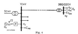
Beispiel einer Parallelankopplung dreiphasiger Signalströme an das Mittelspannungsnetz  $P_R$  Ohmsche Belastung;  $P_M$  Motorenbelastung
