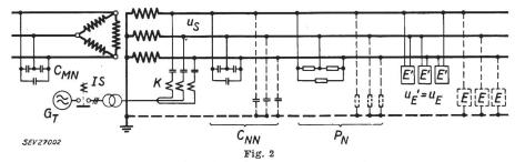
Parallelankopplung dreiphasiger Signalströme an das Niederspannungsnetz (Wenn kein Nulleiter vorhanden ist, fallen die gestrichelt gezeichneten Partien weg)
