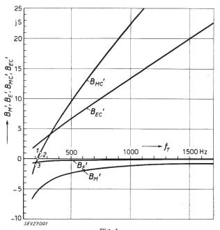
Fig. 1 Blindleitwerte in jS pro 0,144 MW Wirkbelastung in Funktion der Tonfrequenz  $f_T$ , bezogen auf 0,38 kV
