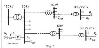
Beispiel einer Parallelankopplung dreiphasiger Signalströme an das Hochspannungsnetz
