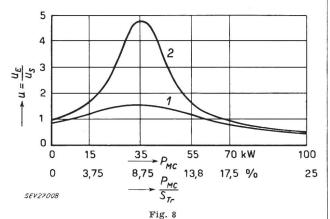
Spezifische Empfangsspannung u in Funktion der kompensierten Motorenbelastung  $P_{M0}$  in den Anlagen nach Fig. 4 und 5
