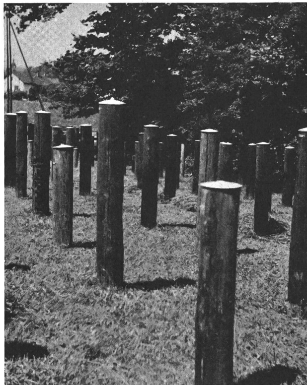
Fig. 27 Détail d'un des champs d'essai pour poteaux imprégnés près de Rathausen
