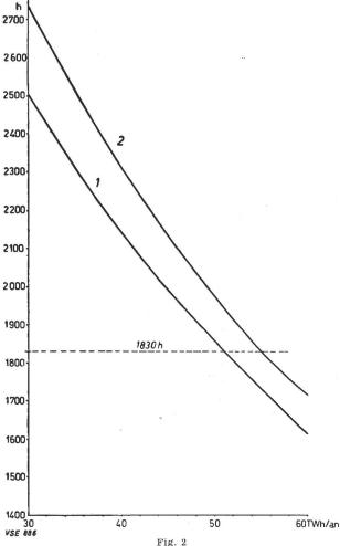
Durée d'utilisation théorique optimum d'hiver des usines hydroélectriques à accumulation en fonction de la production globale d'énergie électrique
