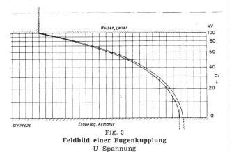
Rechnungsbeispiele und die Messungen an Fugenmodellen zeigen, dass diese Fugen ein ganz ausserordentlich wertvolles Bauelement der Hochspannungstechnik sind, dem eine grosse Bedeutung zukommen wird. Die Abmessungen der Fugen sind Bei der konstruktiven Bearbeitung der Anlage müssen einige für alle Apparate geltende Bedingungen eingehalten werden:
