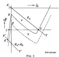
Emitter-Charakteristik und Lastlinie der Zählketten-Transistoren
