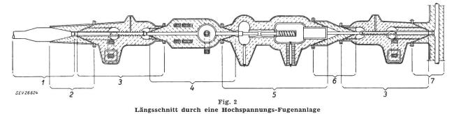
1 Kabel; 2, 6 Übergangsstück; 3 Trenner; 4 Messwandler; 5 Druckluftschalter; 7 Sammelschiene
