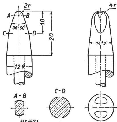
Doigt métallique pour l'examen du danger de contact des parties sous tension
