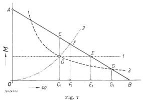
Couples M en fonction de la vitesse angulaire de rotation  $\omega$   $\overline{AB}$  Couple de la turbine en fonction de sa vitesse angulaire;  $\overline{CC}_1$  Couple en régime nominal; 1 Couple constant (machinesoutil); 2 Couple proportionnel à  $j^2$  (ventilateurs, pompes; 3 Couple proportionnel à 1/f (résistances pures)
