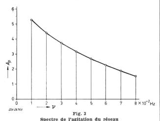
A<sub>p</sub> amplitude des variations de puissance  $\nu$  fréquence d'agitation
