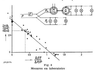
Réseau constitué par un groupe de lampes à incandescence  $(P_R)$  et un moteur asynchrone monophasé chargé par une génératrice alimentant aussi des lampes  $(P_M)$
