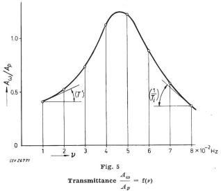
T' promptitude du régulateur;  $T_4$  inertie spécifique;  $\nu$  fréquence d'agitation
