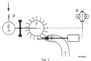
Schéma du réglage a Cause: perturbations; b Effet: variation de la vitesse G Génératrice: T Turbine
