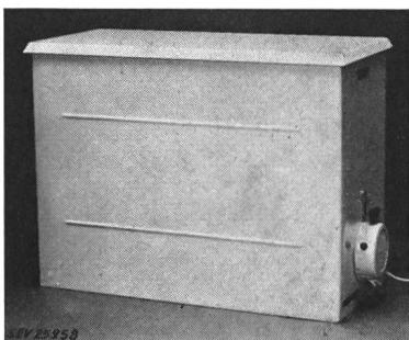
mique. Entraînement du ventilateur par moteur monophasé autodémarreur, à induit en court-circuit. Lampe témoin et coupe-circuit thermique. Cordon de raccordement à trois conducteurs sous double gaine isolante, fixé au séchoir, avec fiche 2 P + T. Poignée en matière isolante moulée. Le linge se suspend à des barres dans le coffre.
