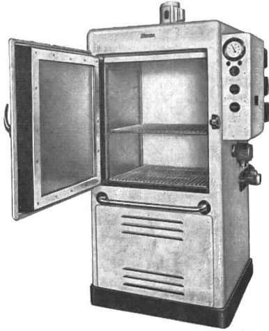
Fig. 4 «Therma»-Prüfschrank mit Temperatur- und Feuchtigkeitsregelung
