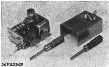
Ce distributeur automatique d'essence est conforme au 4<sup>e</sup> projet des «Prescriptions pour le matériel antidéflagrant», mode de protection à sécurité renforcée, groupe d'allumage D. Utilisation: dans des locaux présentant des dangers d'explosion par des gaz ou vapeurs du groupe d'allumage D.
