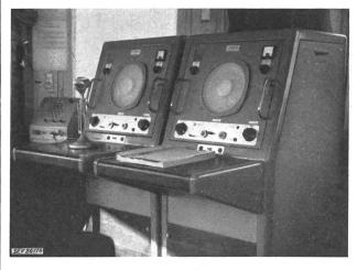
Fig. 14 Anzeigeapparatur der Gonio-Peilanlage im Kommandoturm
