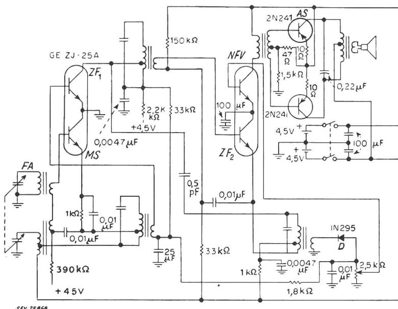
Die restliche Schaltung des Empfängers ist konventionell. Die Ausgangsstufe gibt eine unverzerrte Leistung von 150 mW ab. T. Brenig
