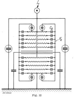
Kapazitives Schema für Spannungswandler mit einem Eisenkörper C Lagenkapazität;  $C_R$  Erdkapazität;  $F_\sigma$  Eisenkörper
