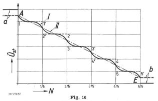
Stoßspannungsverteilung in einer Lagenwicklung  $\hat{v}_{st}$  Stoßspannung; N Windungszahl; I Anfangsverteilung; II Endverteilung; A Wicklungsanfang; E Wicklungsende; a Cu-Belag aussen; b Cu-Belag innen
