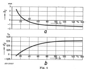
Fehlerkurven eines 220-kV-Stromwandler-Messkernes für 60 VA, Klasse 0,2
