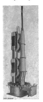
Beim Stromwandler ist die Stoßspannungssicherheit dadurch erreicht, dass ihn die erwähnten Potentialeinlagen einer grobgestuften Kondensatordurchführung gleichmachen. Durch geeignete Dimensionierung erhält man leicht eine Längs- und Quersteuerung der Isolation, wie sie die vorgeschriebene Stoßspannung verlangt.
