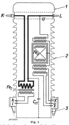
Prinzipschema der magnetischen Messgruppe K—L Primärwicklung des Stromwandlers; k—l Sekundärwicklung des Stromwandlers;  $Fe_I$  Eisenkörper des Stromwandlers;  $C_{IT}$  Eigenkapazität des Stromwandlers; U—X Primärwicklung des Spannungswandlers; u—x Sekundärwicklung des Spannungswandlers;  $Fe_U$  Eisenkörper des Spannungswandlers; I Ausdehnungsgefäss; I Isolator; I Kessel mit Kabelkasten
