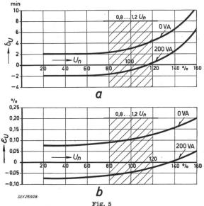
Fehlerkurven eines 220-kV-Spannungswandlers bei 0 und bei 200 VA, Klasse 0,2
