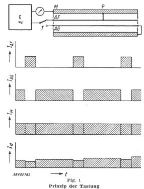
G Tongenerator; T Umtaster; M Mantel; P Fehlerstelle; AF fehlerhafte Ader; AG gesunde Ader;  $I_{AF}$ ,  $I_{AG}$ ,  $I_{M}$  Prüfstrom;  $I_{d}$  Differenzstrom: Überstreuen von «Punktenergie» in das «Strichgebiet» ändert den Charakter der Strichzeichen nicht; t Zeit
