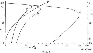
Ventilatorantrieb mit drosselspulegesteuertem Kurzschlussankermotor
