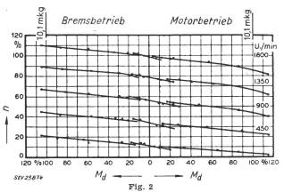
Drehmomentkennlinien eines drosselspulgesteuerten Zweiwicklungs-Schleifringankermotors von 18,5 kW bei 220 V, 60 Hz n Drehzahl;  $M_d$  Drehmoment
