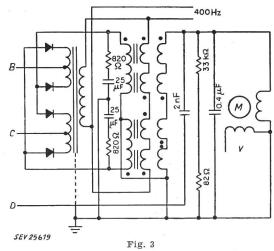
Sättigbarer Ausgangs-Transformator, 7,5 W
