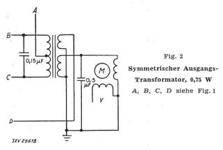
formator sind noch Schaltelemente vorhanden, welche die Schwingneigung des Verstärkers herabsetzen.
